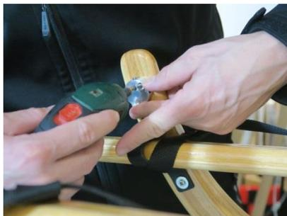
Im nächsten Schritt kann man bereits die Halterung montieren. Alle drei Schrauben kräftig anschrauben, aber natürlich nicht im Holz mit Gewalt durchdrehen.
